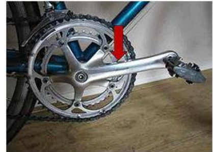
De rechtercrank als onderdeel van een racefiets met twee gemonteerde kettingwielen
